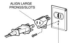
ENSURE PROPER GROUND AND FIRM CONNECTION BEFORE USE
