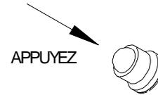
10. Si vous n'avez pas d'allumage dans les 5 secondes, fermez les boutons de commande et la bouteille de gaz et faites un test d'étanchéité sur TOUS les raccords et sources de gaz, comme décrit dans la section Utilisation et Entretien de ce manuel. Si vous ne décelez aucune fuite, attendez 5 minutes pour que le gaz se dissipe et essayez à nouveau d'allumer le brûleur.
