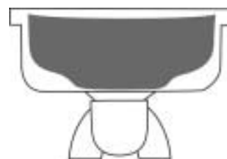
Café nivelado adecuadamente
