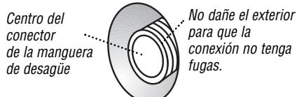
**2.** Perfore únicamente el centro del conector de la manguera de desagüe. Use una broca de  $\frac{1}{4}$  pulg. como mínimo.
