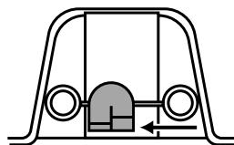
La posición "Alta": el Flotador de Nivel del Agua está preseleccionado en la posición de "alta", al lado izquierdo de la abertura. El deshumidificador se apagará automáticamente cuando el balde esté  $\frac{3}{4}$  lleno.
