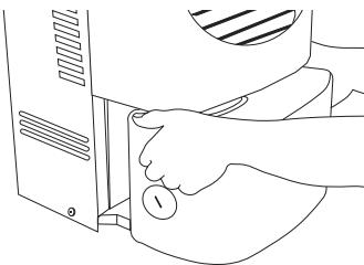
1. Levante el balde utilizando las dos agarraderas laterales. Tire del balde hacia usted, para sacarlo.
