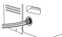
**3.** Coloque una manguera de patio en el conector de la manguera de desagüe. La manguera de jardín no debe tener una longitud mayor de 8 pies (2,4 m). Haga pasar el otro extremo de la manguera de patio por un desagüe de piso. Verifique que la manguera esté plana y en el desagüe.
