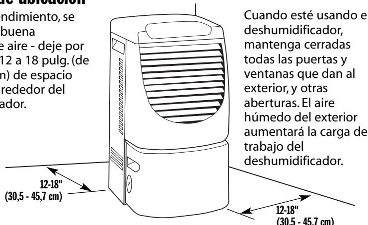
Cuando esté usando el deshumidificador, mantenga cerradas todas las puertas y ventanas que dan al exterior, y otras aberturas. El aire húmedo del exterior aumentará la carga de trabajo del deshumidificador.
