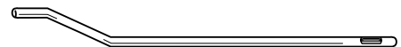
(ENG) Steering Column (FR) Colonne de direction (ESP) Columna de mando (P) Coluna da Direção
