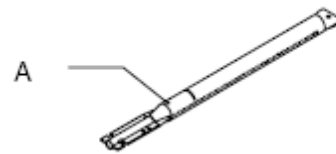
A. Vis de réglage de l'admission d'air
