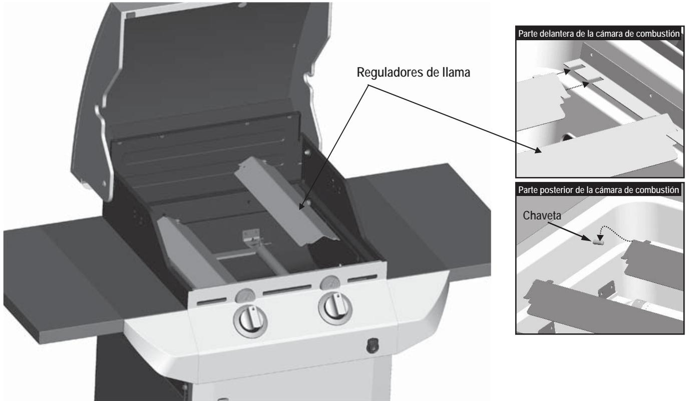
**14** Coloque las parrillas de cocción en la cámara de combustión, como se ilustra. Inserte los extremos de los dos alambres de la parte posterior de la rejilla para calentar alimentos, en los orificios ubicados en la parte posterior de la cámara de combustión. Los alambres de la parte delantera de la rejilla para calentar alimentos se apoyan en los lados de la cámara de combustión.
