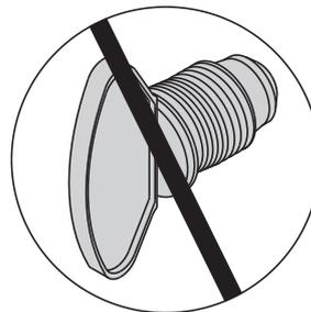
¡No use un tapón POL para transporte (la pieza de plástico con roscas en el exterior)! Anulará la característica de seguridad de la válvula.
