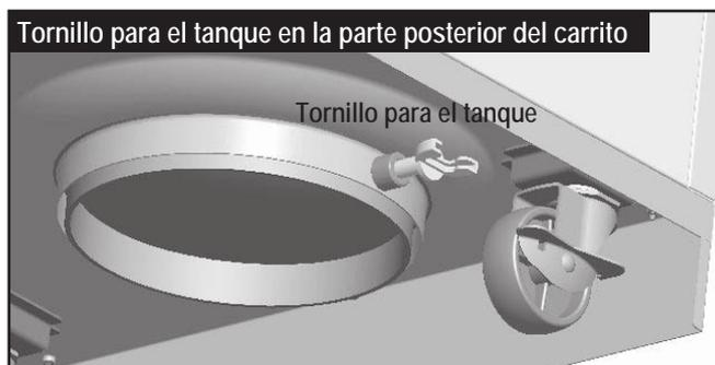
Siempre mantenga los tanques de gas en posición vertical durante su uso, transporte y almacenamiento.
