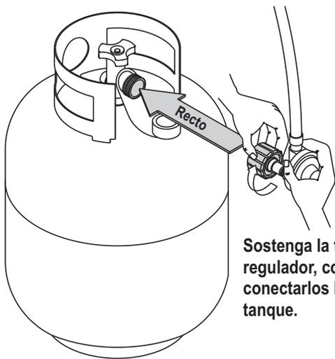
Sostenga la tuerca de unión y el regulador, como se ilustra, para conectarlos bien a la válvula del tanque.
