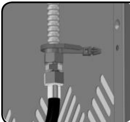
Clip hose to side panel using hose retainer clip supplied. Fixez le boyau au panneau latéral à l'aide de la clip de retenue fournie.
