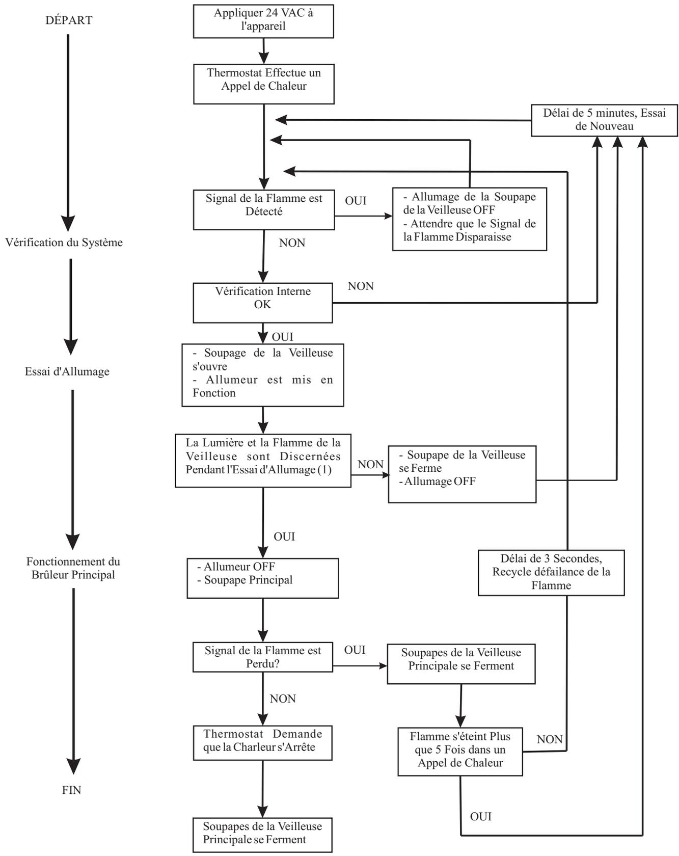
(1) L'allumeur se fermera après 30 secondes d'essai pour l'allumage si la flamme de la veilleuse n'est pas allumée. Il se remettra en marche pour les 30 dernières secondes des 90 secondes d'essai pour l'allumage. La soupape de la veilleuse sera alimentée durant tout l'essai d'allumage. Ceci est un fonctionnement normal pour ce système d'allumage au gaz.
