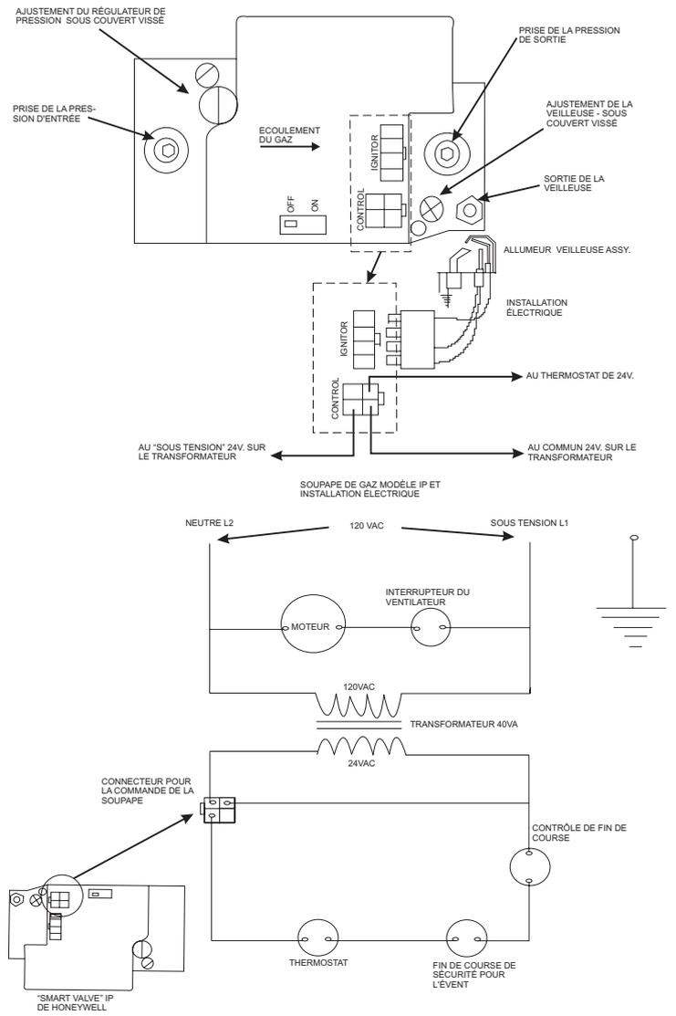
DIAGRAMME À L'ÉCHELLE DE L'INSTALLATION ÉLECTRIQUE SOUPE IP
