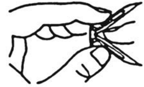
Fig. 17 - Cómo doblar el soporte de expansión
