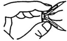
Fig. 17 - Cómo doblar el soporte de expansión
