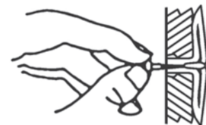
Fig. 19a - Instalación de separadores de colgador de pared en el calefactor
