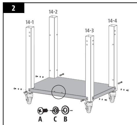
**IMPORTANTE:** El borde de la repisa inferior que tiene los orificios debe estar hacia el frente. Los orificios son para la instalación de las puertas del gabinete.
