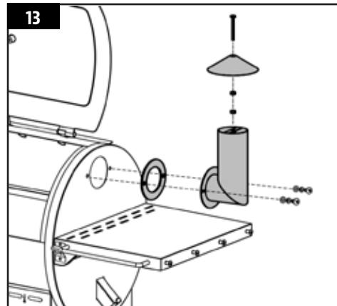
**NOTA: Ajuste la tapa de la chimenea para modificar el flujo de aire dentro del asador. Si cocina a baja temperatura, mantenga la tapa más abierta. Asegúrese de que la tapa de la chimenea permita que escape el aire.**
