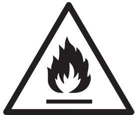
Riesgo de incendio/ materiales inflamables (Requerido para unidades R32 / R290 solamente)
