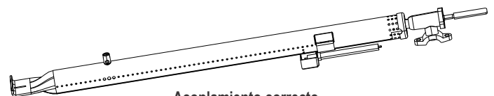
Acoplamiento correcto del quemador con la válvula
